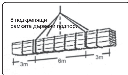
Фигура 2: Разтоварване на 12 метров палет с кран
